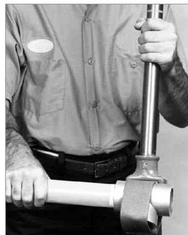
Serrer les raccords à la main, puis visser de 1/2 à 1 tour de plus. Éviter de trop serrer pour ne pas étirer ou déformer le tuyau, le raccord ou les filets.
