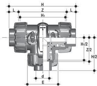
Raccordements à emboîtement IPS – Dimensions (pouces)
