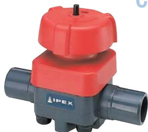
Le coefficient de débit ( $C_v$ ) se définit comme le débit en gallons par minute (gpm), à 68°F, produisant une chute de pression de 1 psi dans un robinet entièrement ouvert. Ces valeurs sont établies à l'aide d'une procédure d'essai normalisée dans l'industrie, le fluide utilisé étant de l'eau (densité de 1,0). La formule suivante sert à calculer la chute de pression en fonction du débit :
