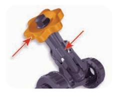
VOLANT ET TIGE FILETÉE – les nombreux filets permettent un réglage linéaire précis du débit au moyen d'un volant ergonomique à plusieurs tours.
